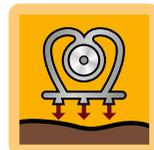
**8.** Отводить пыль от протравленных семян к поверхности почвы при использовании пневматических вакуумных сеялок
