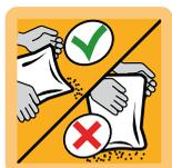
**6.** Аккуратно заполнять бункер сеялки, позволяя семенам самостоятельно высыпаться из наклоненного мешка. Не переворачивать мешок, не пересыпать в сеялку пыль со дна мешка
